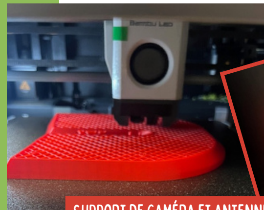
SUPPORT DE CAMÉRA ET ANTENNE RÉALISÉ PAR UNE IMPRIMANTE 3D
